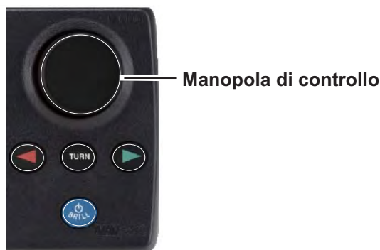
Manopola di controllo rotta (NAVpilot-700)
